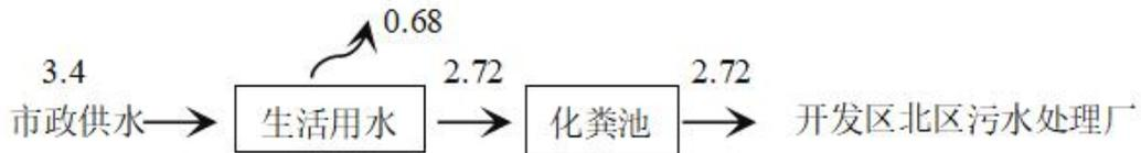
图 2-1 项目用水平衡图 (m<sup>3</sup>/d)
